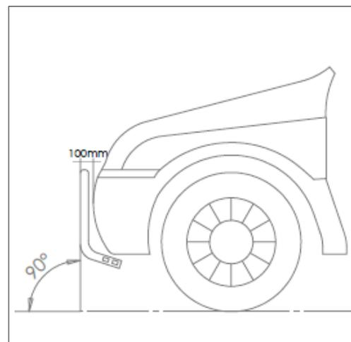
O tubo "1" deve ser fixado de modo que esteja em um ângulo de 90° em relação ao solo, conforme mostra a figura. Deve ser observado também que o tubo não deve ultrapassar a distância máxima de 100mm do ponto mais avançado do veículo.
