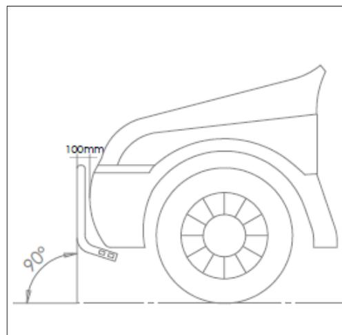
O tubo "1" deve ser fixado de modo que esteja em um ângulo de 90° em relação ao solo, conforme mostra a figura. Deve ser observado também que o tubo não deve ultrapassar a distância máxima de 100mm do ponto mais avançado do veículo.
